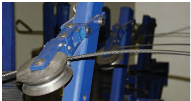
Umlenkrollen der Richtanlage
