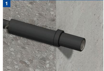
Der Betonstahl wird mit vormontiertem Hülsesteil der Kupplung auf die Baustelle geliefert und mittels Nagelteller an der Schalung fixiert. Beim Montieren muss darauf geachtet werden, dass das Gewinde nicht verletzt wird, oder Beton in den Hülsesteil eindringt. Nach dem Entfernen der Schalung und dem Öffnen des Hülsesteils wird der Anschlusssteil mit der Kontermutter in den Hülsesteil eingeschraubt.
