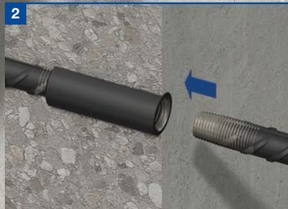
Nach dem Entfernen der Schalung und dem Öffnen der Kupplung wird der Anschlussstab in die Kupplung eingeschraubt.
