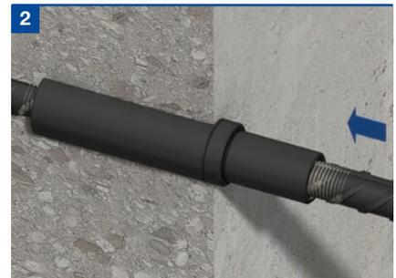
Nun wird der Anschlussstab in den Anschlusssteil der Kupplung eingebracht. Dabei muss der Anschlussstab so nahe wie möglich an den einbetonierten Hülsesteil gebracht werden.
