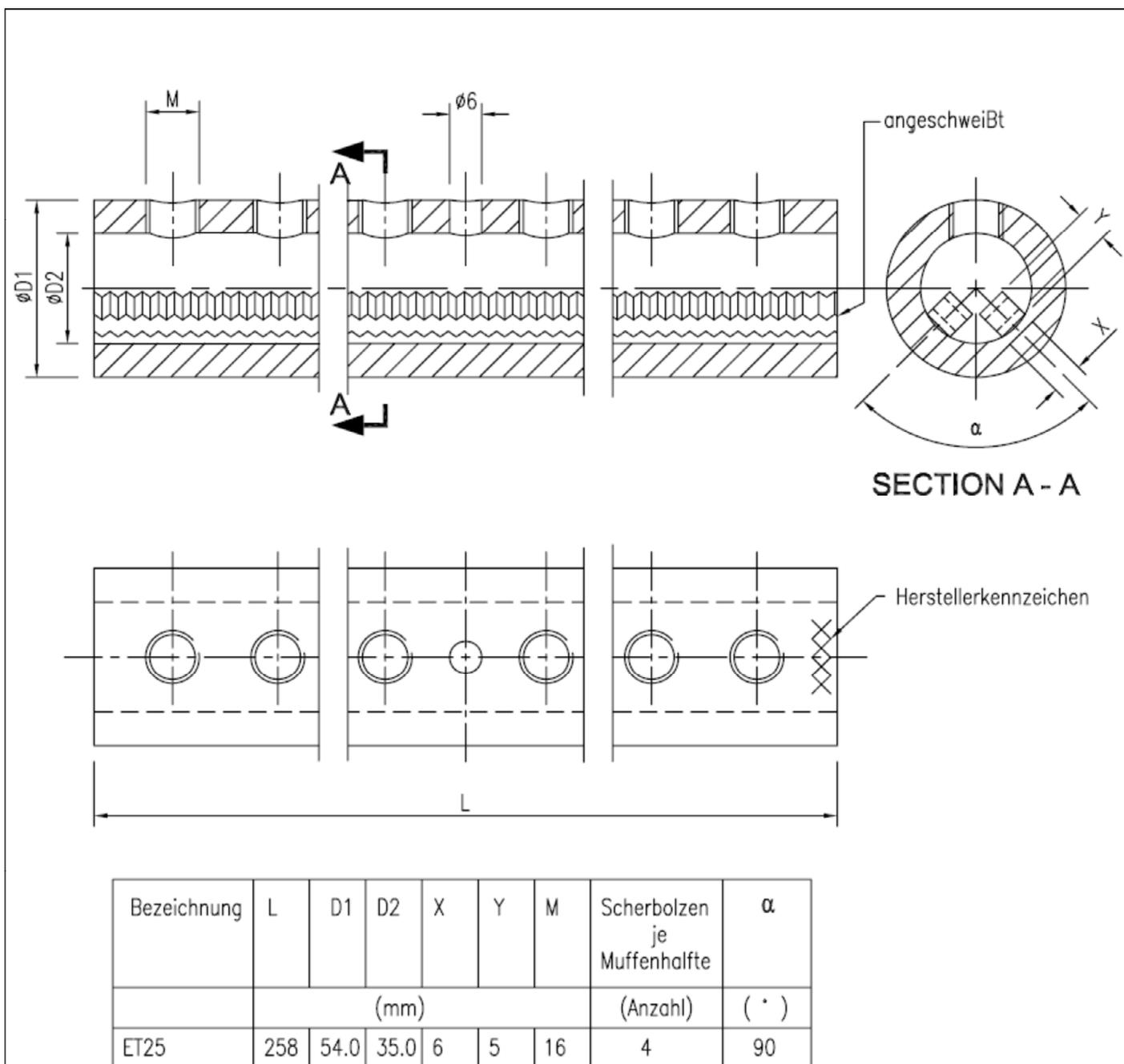
Muffenverbindung von Betonstabstahl mittels Scherbolzen und Zahnleisten
