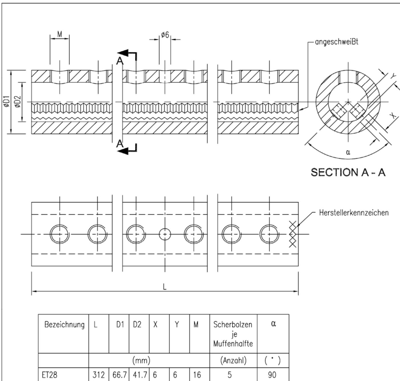
Muffenverbindung von Betonstabstahl mittels Scherbolzen und Zahnleisten
