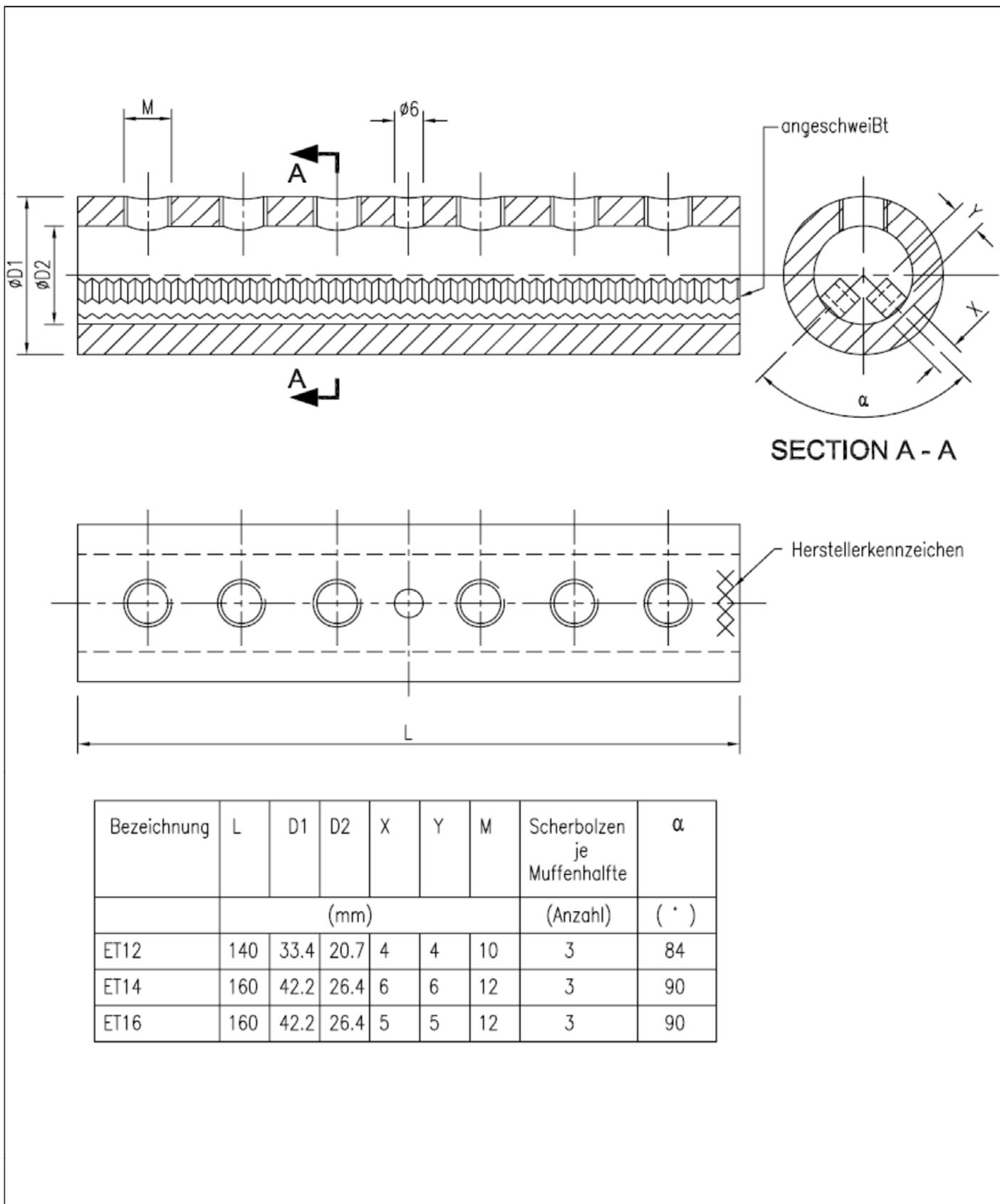
Muffenverbindung von Betonstabstahl mittels Scherbolzen und Zahnleisten
