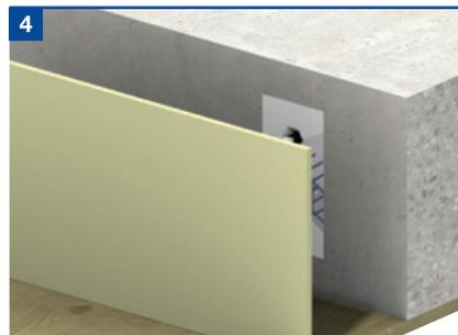
Nun kann die Fuge mit Fugenfüllmaterial in passender Stärke ausgekleidet werden.
