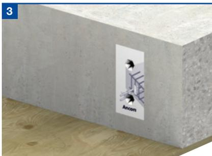
Nachdem der Beton eine ausreichende Festigkeit erreicht hat kann die Schalung entfernt werden. Nun kann der Aufkleber auf dem eingebauten Hülseenteil entfernt oder durchstochen, und der Dorn eingebracht werden. **Wichtig:** Bei der Verwendung von querbeweglichen Dornen (DSDQ) sollte der Aufkleber immer mittig durchstochen werden, sodass nur der zylindrische Hülseenteil, der mittig in der Rechteckhülse sitzt, für den Dornenteil frei wird und der restliche Teil der Hülse geschützt bleibt.
