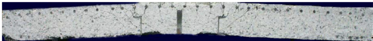
Bild 46: Schnittbilder von Platten nach dem Durchstanzversuch von a) einer Platte ohne Durchstanzbewehrung [Guandalini], b) von einer Platte mit Durchstanzbewehrung und c) mit einem Stahlpilz und Durchstanzbewehrung.
