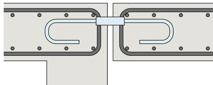
ANCRA®-Z est un tirant pour la reprise de charges de traction. Avec l'habillage en mousse, des charges transversales peuvent être reprises. Selon le projet, toutes formes et dimensions sont réalisables.
