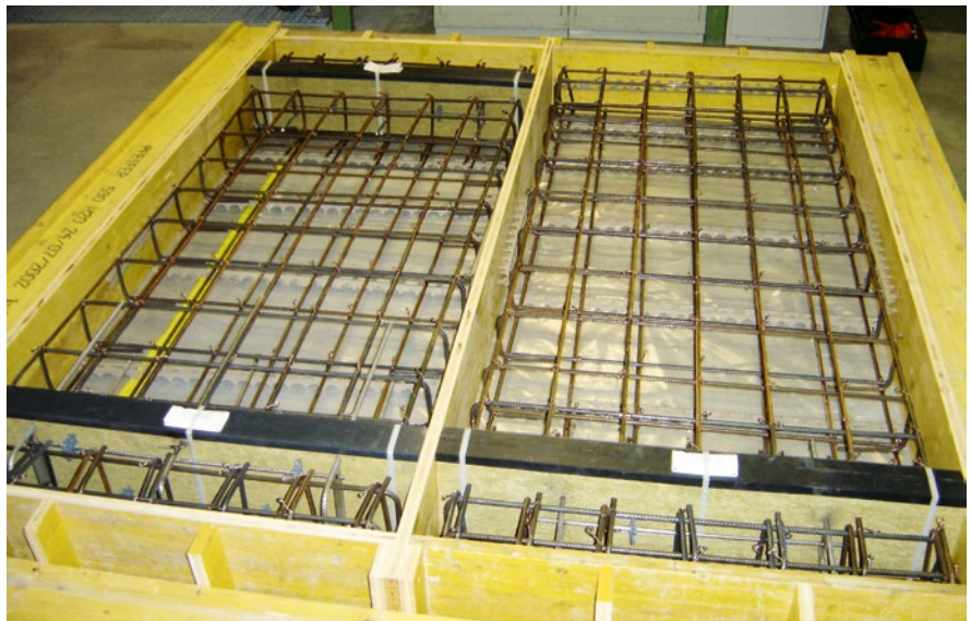
Armature des dalles d'essais. A gauche : avec Ancon-Iso, à droite: dalle de référence intégrale en béton.
