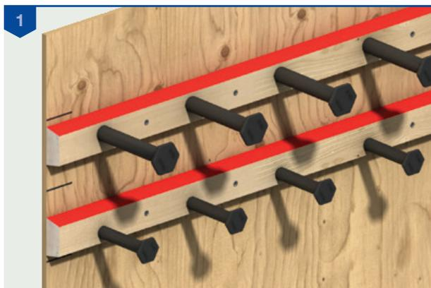
Le profilé porteur d'ancrages est positionné contre le coffrage à l'emplacement du plancher à connecter, orienté selon les instructions sur l'étiquette adhésive, qui précisent que la tranche colorée doit être située vers le haut. Le profilé est fixé au coffrage à l'aide de clous. Il est important que le profilé soit réglé dans la position correcte et dans les tolérances requises, qu'il soit à l'endroit, et fixé afin d'éviter tout déplacement en cours de bétonnage.
