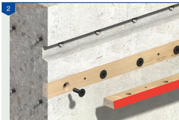
Le reste du ferrailage du voile doit être mis en position selon les prescriptions du concepteur, sur la base de nos recommandations. Le béton est ensuite coulé et lorsqu'il a atteint la résistance suffisante, le coffrage est enlevé, exposant la face du profilé porteur et son ruban adhésif protecteur.
