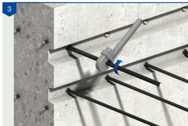
Les ancrages KSN doivent être utilisés exclusivement avec des armatures de deuxième phase CXL.
