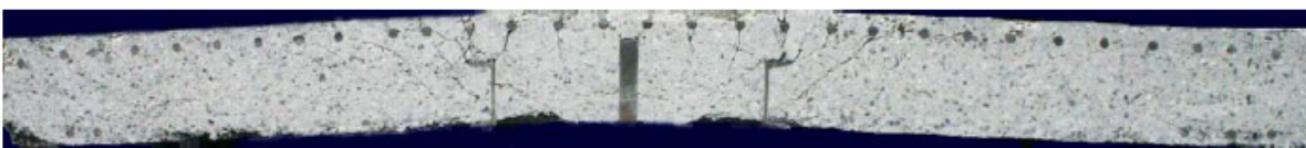
Ill. 46 : Photos de dalles en coupe après l'essai de poinçonnement a) d'une dalle sans armature de poinçonnement [Guandalini], b) d'une dalle avec armature de poinçonnement et c) avec une tête en acier et une armature de poinçonnement.
